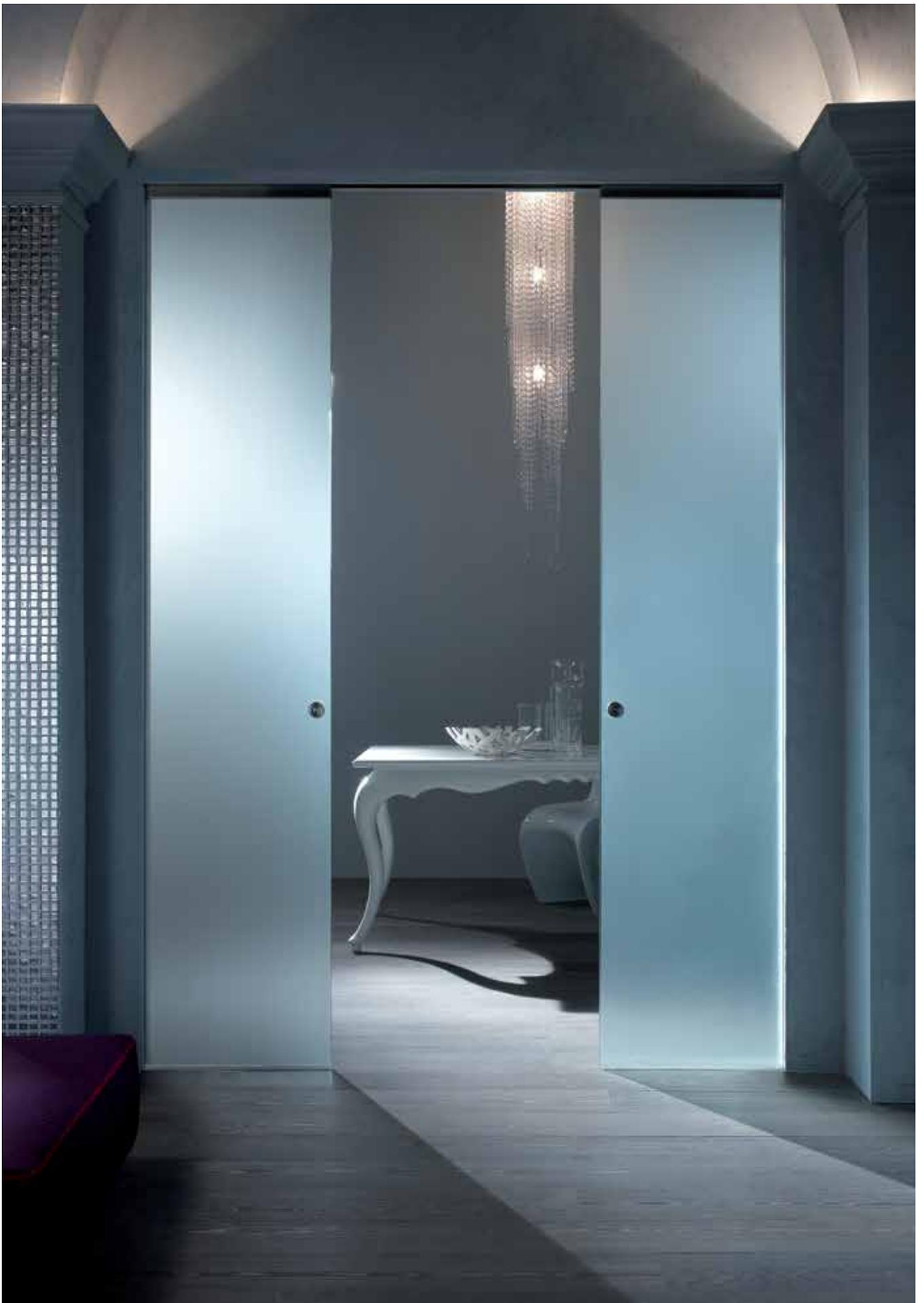
Das System ist in den Versionen mit Einzel- und Doppelflügel sowohl für gemauerte als auch für Gipskartonwände verfügbar. Ferner besteht die Möglichkeit, die Übermaßversion mit auf den Zentimeter anpassbaren Höhen zu liefern.
