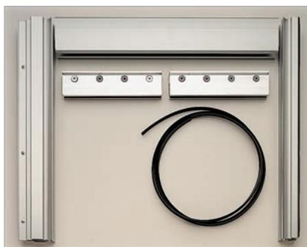
Ein technisch hochwertiges System aus eloxiertem Aluminium, das die Realisierung einer Glasschiebetür mit Minimalspalz in modernem Design erlaubt. Eine Bohrung des Glases ist nicht erforderlich, Tragkraft 80 kg, für Glasstärke 10 mm. Einsetzbar mit Holz- oder Aluminiumzargen. Sonderhöhen bis 2400 mm verfügbar.
